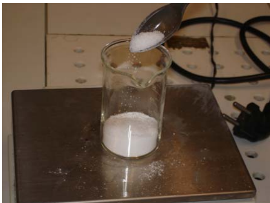
Abwiegen der Zitronensäure (im Glas ist bereits das Backpulver)
